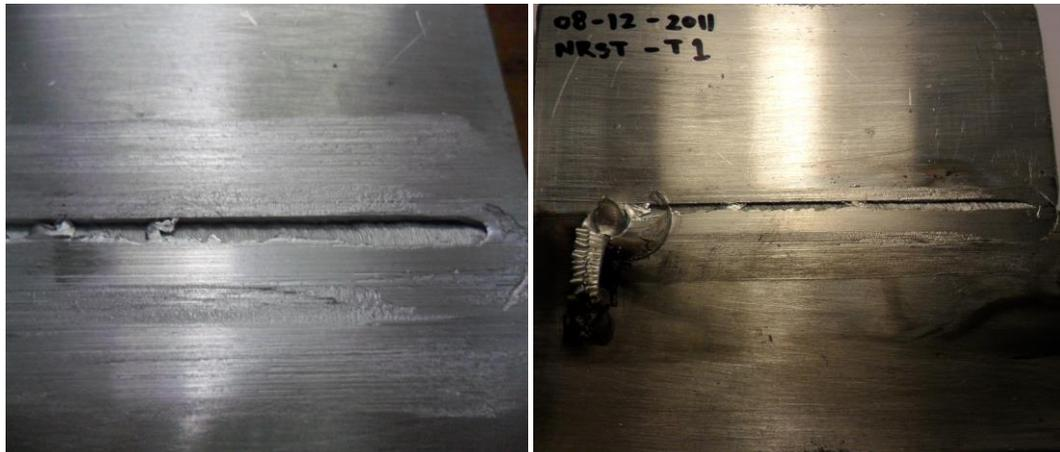
a).  $\omega = 950 \text{ rpm}$ ;  $v = 67 \text{ mm/min}$ ,  $d = 6,1 \text{ mm}$
