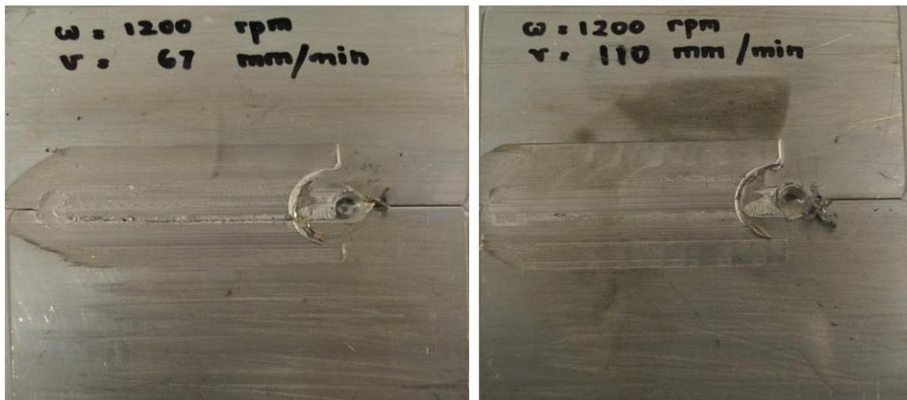
c).  $\omega = 1200 \text{ rpm}$ ;  $v = 67 \text{ mm/min}$ ,  $d = 6,1 \text{ mm}$
