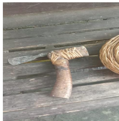
Gambar 4. Alat kapak untuk menyadap getah damar (Sumber: observasi penelitian, 2021)
