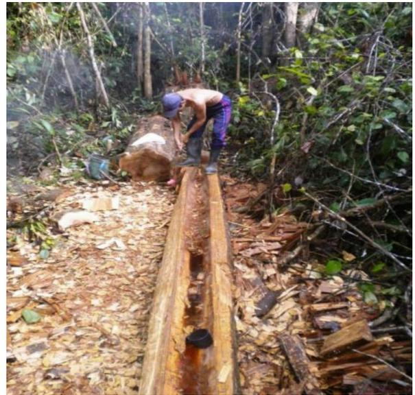
**Gambar 1.** Pemotongan Pohon Ulin Untuk Membuat Kerangka Jukung
