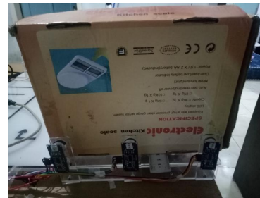
Gambar 11. Pengujian Sensor P1 - P3 Jarak 3 cm
