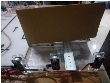
Gambar 10. Pengujian Sensor P1 - P3 Jarak 13 cm
