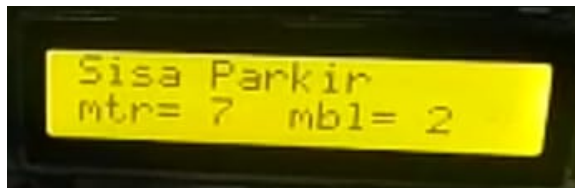
Gambar 14. Tampilan Uji Coba LCD Dengan Model I2C
