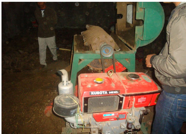
Gambar 6. Mesin Chopper yang Telah Dimodifikasi pada Pisau Pemotong Menjadi Alat Penghancur (Cruiser) dengan Alat Penghancur dari Baja.
