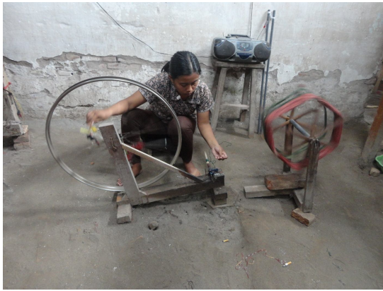
Gambar 8. Proses Pengulungan Benang
