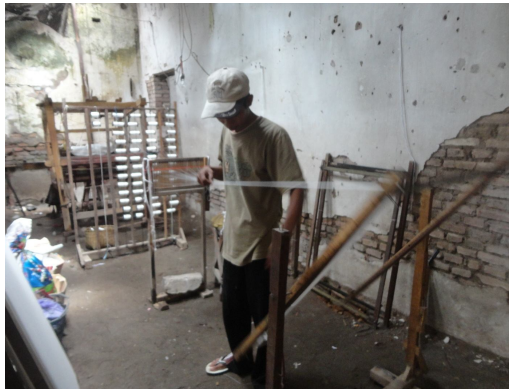
Gambar 9. Proses Palat/Menata Benang
