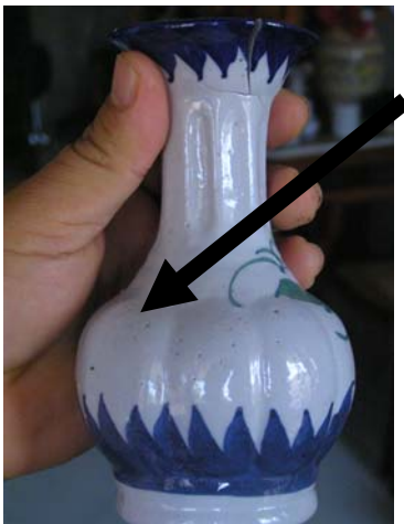
Gambar 10 Permukaan Produk Ada Lubang jarum X 9
