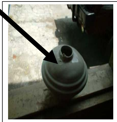
Gambar 5 Permukaan Produk Tidak Halus/ rata atau Permukaan kulit jeruk) X 4
