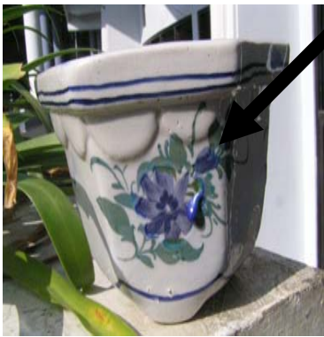
Gambar 8 Dekorasi Glasur Kembangan Mengelupas X 7
