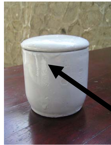
Gambar 11 Bekas glasur yang menetes pada permukaan luar X 10
