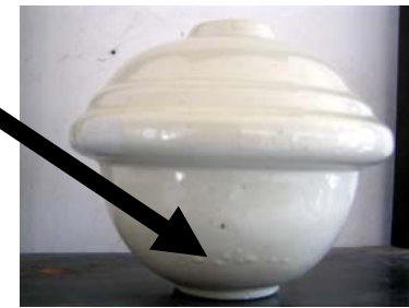
Gambar 13 Permukaan bergelembung kecil X 11
