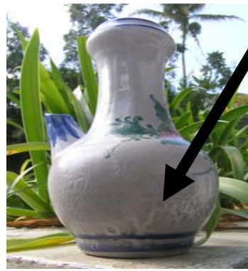
Gambar 9 Permukaan Produk Ada Warna Jelaga Hitam X 8
