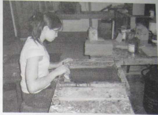
Foto 1. Pembuatan Sablon PCB Secara Manual
