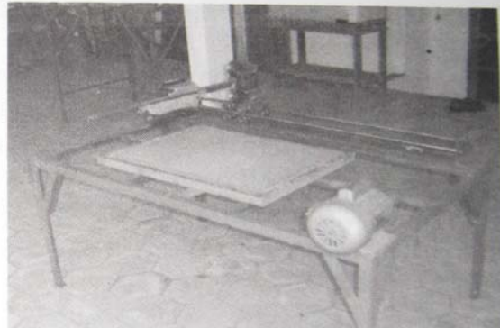
Foto 2. Mesin Sablon Otomatis PCB Otomatis
