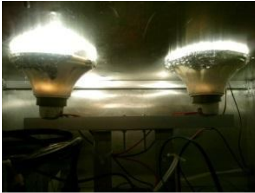
Gambar 20. Sumber panas incubator digunakan lampu pijar
