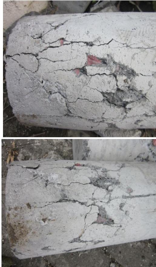
Gambar 10. Gambar Pola Retak Beton
