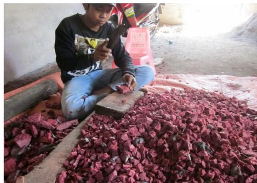
Gambar 5. Bongkahan plastik menjadi agregat
