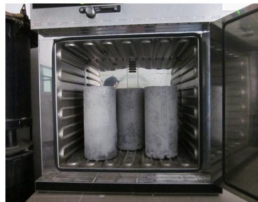
Gambar 8. Benda Uji di Oven
