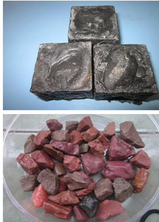
Gambar 6. Agregat Ringan Buatan dari limbah plastik HDPE
