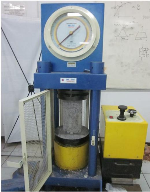
Gambar 9. Pengujian Tekan Silinder Beton
