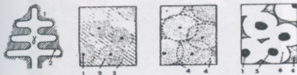
Gambar 2. Pembentukan grafit bulat dalam austenit super jenuh.
