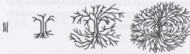
Gambar 16. Tahapan pertumbuhan grafit bulat group 1 [Karsay S.L., 1980]
