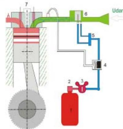
Gambar 1. Instalasi Kit Konversi Eksperimental model 1
