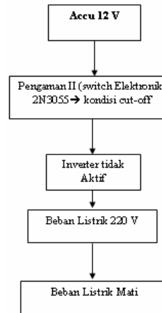
Gambar 3. Diagram blok pemakaian beban listrik optimal
