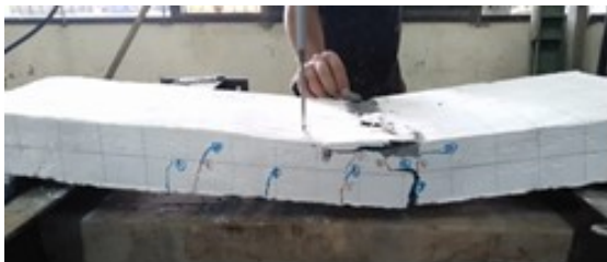
Gambar 6. Pola retak lentur pada panel dinding
