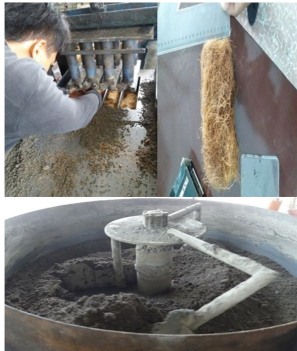
Gambar.1 Pembuatan batako yang diisi sabut kelapa
