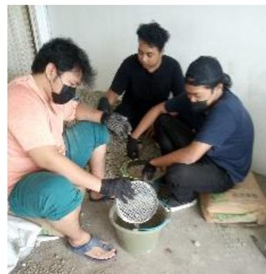
Gambar 9. Proses Penyaringan Agregat Kasar
