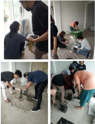
Gambar 10. Proses Penimbangan Material, Pencampuran Agregat Halus, Pengadukan Beton dan Pencetakan Beton
