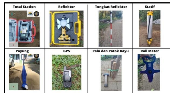
Gambar 2. Alat yang digunakan dalam survei topografi
