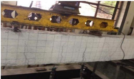
Gambar 8. Pola keruntuhan balok beton bertulang bambu 3D12
