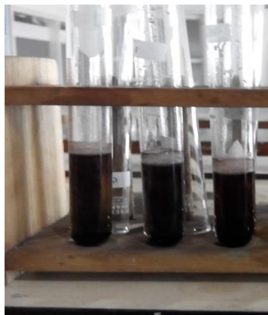
Gambar 1. Sampel yang Positif Mengandung Klorin (Berubah Warna Menjadi Biru)
