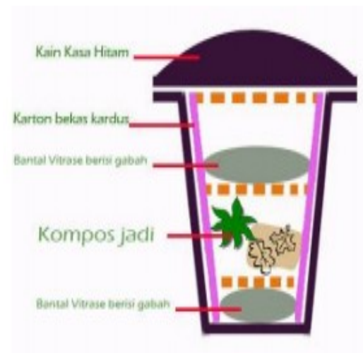
Gambar 3. Desain Keranjang Takakura
