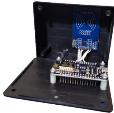
Gambar 10. Rangkaian reader IoT
