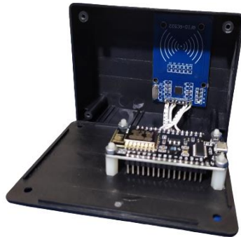
Gambar 10. Rangkaian reader IoT
