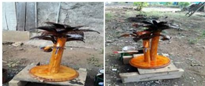
Memasukan kabel ke dalam tiang penyangga, dan pemberian sirlak serta melamin agar terlihat lebih cantik
