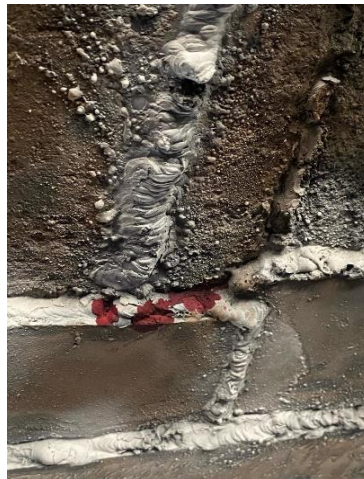
Gambar 2. Hasil Pengujian Penetrant Test
